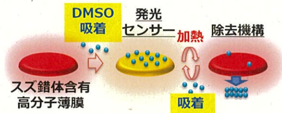
スキーム2 高分子フィルムを用いた揮発性分子の検出・除去システム
